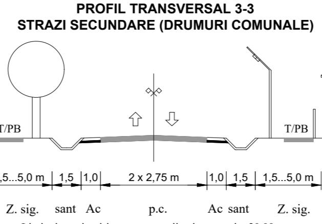
LEGENDA: pc - parte carosabila, p - platforma drum, ac - acostament, bi - banda de incadrate, T/PB - trotuar / pista pentru biciclisti, Z.sig. - zona de siguranta
