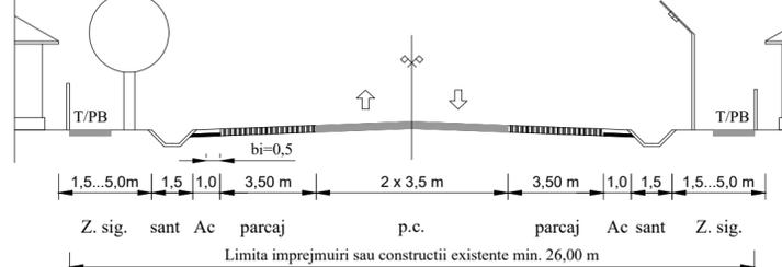
**LEGENDA:** pc - parte carosabila, p - platforma drum, ac - acostament, bi - banda de incadrare, T/PB - trotuar / pista pentru biciclisti, Z.sig. - zona de siguranta
